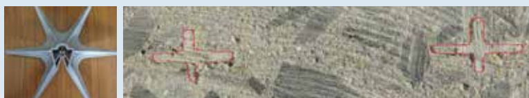
←コンクリートを打設した星型スパーサ（プラ・スターG）の断面図
