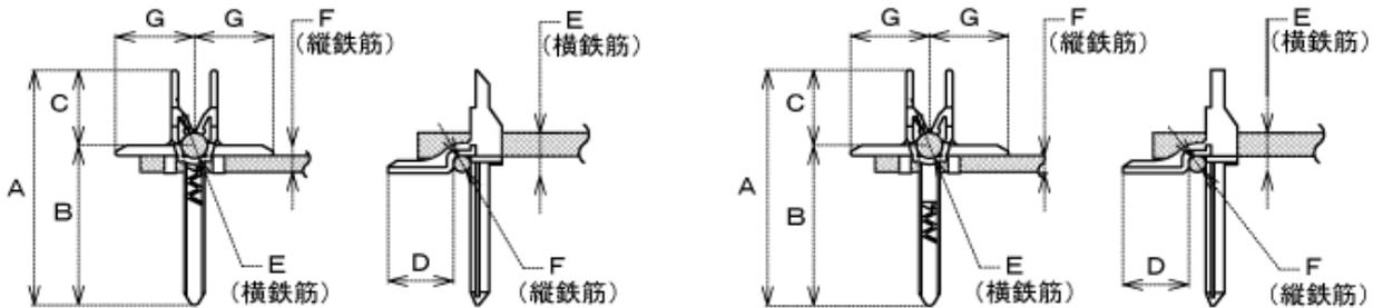
【落蓋式U形側溝3種蓋平打用 JIS A5372-2004】
