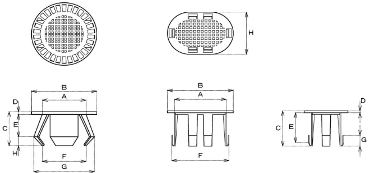
【排水用耐熱フィルター(透水性舗装用)】
